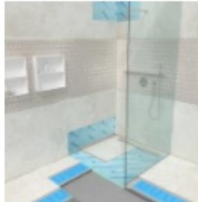
**Per rifinire il perimetro del piano doccia e, allo stesso tempo, sostenere il vetro protettivo** ecco invece **Proshower Profile**, regolabile in altezza, che raccorda piastrelle posate in piano a piastrelle posate in pendenza. Infine **per il deflusso delle acque verso lo scarico c'è Proshower Drain**, una **canalina modulare** disponibile in cinque diverse altezze e in sei griglie di finitura in acciaio inox, che dona un tocco di design evitando ristagni maleodoranti.
